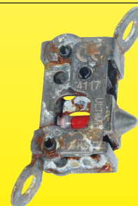
Mecanismo de detección de incendios de acero galvanizado con 240 horas de niebla salina al 20 %
