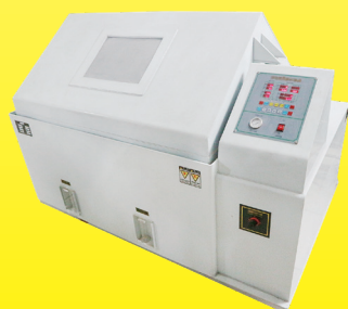
Equipo de prueba para niebla salina en nuestro laboratorio
