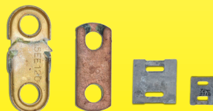
Enlaces fusibles de cobre, latón y recubiertos después de 300 horas de niebla salina al 20 %
